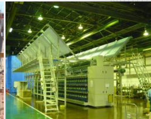
Equipamentos em Teste (Texturizadora)
